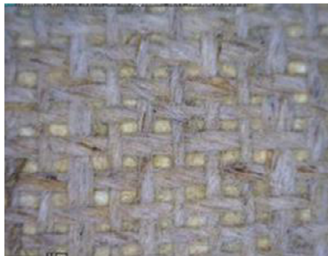
Fig. 5 – Estrutura do tecido, tafetá 1:1 (MO - Dinolite® 59,4 X).
