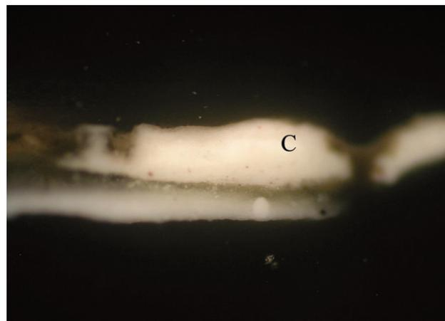
Fig. 18. Corte estratigráfico de amostra recolhida na zona de cor branca da obra *Rio* (OM, ampliação de 200x). A camada cromática composta por branco de chumbo está assinalada com a letra C.
