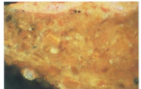
Fig. 46. Exemplo de uma camada vermelha resultante da mistura de vermelhão com cochililha, visível numa amostra recolhida no manto de Cristo da *Aparição de Cristo à Virgem* (amostra 46-96-1). Estratigrafia da base para o topo: encolagem; preparação; [1] camada vermelha (vermelhão e cochililha). Ampliação: 220 x.
