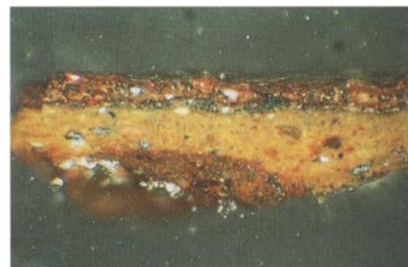
Fig. 44. Amostra da carnação do queixo da figura representada no canto inferior direito da obra *Cristo com a cruz às costas*, de João Gresbante (amostra 35-96-10), onde foi utilizado um pigmento azul. Estratigrafia da base para o topo: encolagem; preparação; [1] camada preta (negro animal e ocre); [2] camada de carnação (ocre, vermelhão, azurite e negro animal). Ampliação: 110 x.
