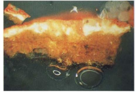
Fig. 35. Corte estratigráfico da amostra tomada na manga do braço direito da Nossa Senhora figurada na *Adoração dos pastores*, que dá conta da ordem pela qual foram pintados os diversos elementos do vestuário (amostra 26-96-7). Estratigrafia da base para o topo: encolagem; preparação; [1] camada branca (branco de chumbo e negro animal); [2] camada vermelha (vermelhão). Ampliação: 110 x.
