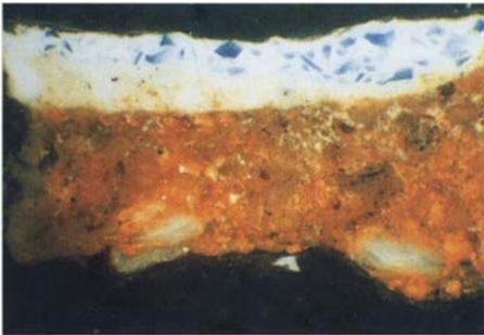
Fig. 29. Corte estratigráfico da amostra recolhida na túnica (zona do ombro) de uma das personagens representada no lado esquerdo da obra sobre o *Batismo de Santo Agostinho*, em que foi detectada a presença de esmalte (amostra 54-96-24). Estratigrafia da base para o topo: preparação; [1] camada castanha (branco de chumbo e ocre); [2] camada azul (branco de chumbo e esmalte). Ampliação: 110 x.
