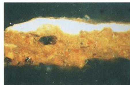
Fig. 16. Amostra recolhida na pintura *Repouso no regresso do Egipto*, na zona do pescoço do anjo que eleva um cesto com frutas, que dá conta da grande irregularidade da superfície da camada preparatória (amostra 44-96-16). Estratigrafia da base para o topo: preparação; [1] camada de carnação (vermelhão e branco de chumbo). Ampliação: 110 x.
