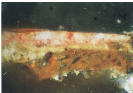
Fig. 54. Amostra da túnica violeta de um dos anjos pintado no canto superior esquerdo da obra *Anunciação*, de Lisboa, na qual a mistura de pigmentos vermelhos e pretos está na origem da cor violeta (amostra 43-96-5). Estratigrafia da base para o topo: preparação; [1] camada castanha (branco de chumbo e ocre); [2] camada violeta (cochinilha, negro animal, branco de chumbo e vermelhão). Ampliação: 220 ×. Foto IJF/M. C. Serrano
