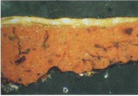
Fig. 28. Amostra da túnica do anjo figurado no canto inferior direito da pintura *Repouso no regresso do Egipto*, em que é visível ocre amarelo (amostra 44-96-1). Estratigrafia da base para o topo: preparação; [1] camada amarela (ocre amarelo e branco de chumbo). Ampliação: 110 x.
