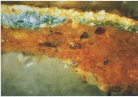
Fig. 33. Amostra recolhida numa zona do manto da Virgem com decoração dourada (braço esquerdo) da pintura representando a *Anunciação*, de Coimbra (amostra 34-96-8). Estratigrafia da base para o topo: preparação; [1] camada azul (azurite, branco de chumbo e negro animal); [2] camada castanha (branco de chumbo e ocre). Ampliação: 110 x.
