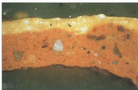
Fig. 42. Amostra da carnção da perna do mendigo figurado no canto inferior esquerdo da obra representando a *Apresentação da Virgem no Templo* (amostra 38-96-1). Estratigrafia da base para o topo: encolagem; preparação; [1] camada de carnção (branco de chumbo, ocre amarelo, vermelhão e negro animal). Ampliação: 110 x.
