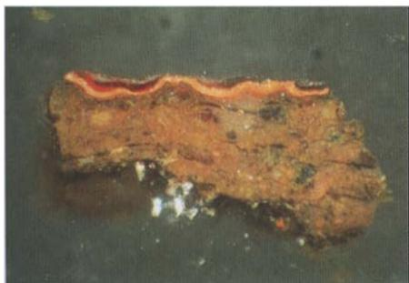
Fig. 48. A única amostra com camadas de cor vermelha em que o vermelhão e a cochililha foram encontrados em camadas separadas. Amostra de uma das flores representada na *Anunciação*, de Estremoz (amostra 56-96-10). Estratigrafia da base para o topo: preparação; [1] camada vermelha (vermelhão); [2] camada vermelha (cochililha). Ampliação: 110 ×.
