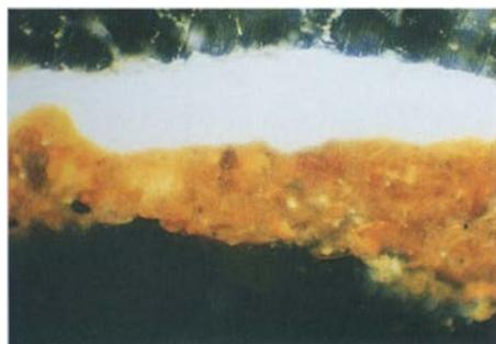
Fig. 25. Amostra recolhida numa zona de luz da flâmula pintada em *Aparição de Cristo à Virgem*, onde foi utilizado branco de chumbo sem qualquer mistura (amostra 46-96-6). Estratigrafia da base para o topo: preparação; [1] camada branca (branco de chumbo). Ampliação: 220 x.
