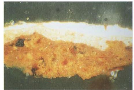
Fig. 36. Amostra do chão, recolhida por baixo do pé esquerdo do Cristo representado na obra *Aparição de Cristo à Virgem* (amostra 46-96-18). Estratigrafia da base para o topo: preparação; [1] camada castanha (branco de chumbo, ocre, vermelhão e negro animal); [2] camada castanha (branco de chumbo e ocre). Ampliação: 110 x.
