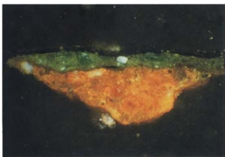
Fig. 32. Corte estratigráfico da amostra recolhida no paramento do sacerdote que preside à cerimónia no *Batismo de Santo Agostinho*, em que é visível verdete ou *verdigris* (amostra 54-96-8). Estratigrafia da base para o topo: preparação; [1] camada verde (verdete e ocre); verniz. Ampliação: 110 x.
