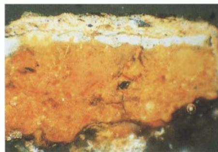
Fig. 23. Amostra recolhida no canto superior esquerdo da pintura *São Mateus*, na zona do céu (amostra 40-96-5). Estratigrafia da base para o topo: preparação; [1] camada cinzenta (branco de chumbo, negro animal e vermelhão); [2] camada castanha (ocre, branco de chumbo, esmalte e vermelhão). Ampliação: 110 ×.
