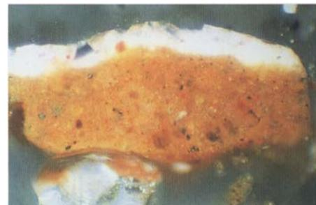
Fig. 53. Amostra recolhida na túnica de Jesus, da pintura representando o *Menino entre os Doutores*, onde a cor violeta resulta da combinação de esmalte com cochilinha (amostra 27-96-23). Estratigrafia da base para o topo: preparação; [1] camada violeta (esmalte, cochilinha e branco de chumbo). Ampliação: 220 x.
