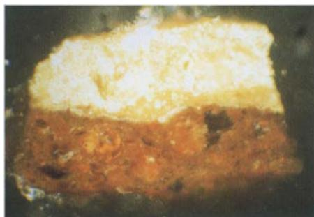
Fig. 49. Amostra da cruz representada na obra sobre a *Aparição de Cristo à Virgem*, onde o ocre amarelo foi utilizado na simulação do dourado (amostra 46-96-4). Estratigrafia da base para o topo: preparação; [1] camada amarela (ocre amarelo). Ampliação: 220 ×.
